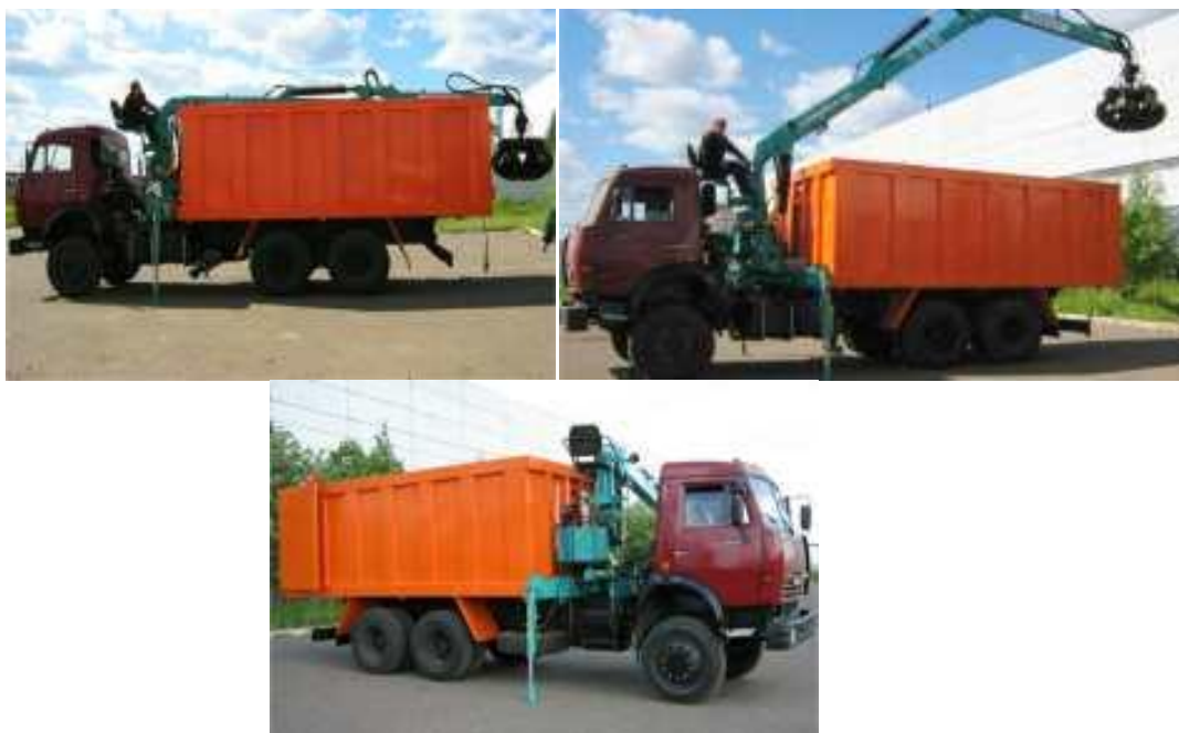
10 - сурет-КАМАЗ-53229-1064 (65115) автокөлігінің шассиындағы кран-манипуляторлы Ломовоз (металловоз).
