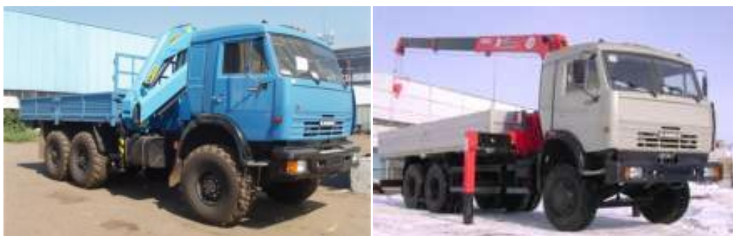
13 – сурет - Кран-манипуляторлы Камаз бортты автокөлігі
