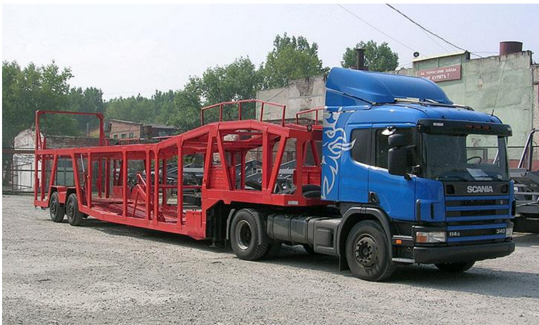
8-сурет-3 немесе одан көп автомобильді тасымалдаушы автовоздар
