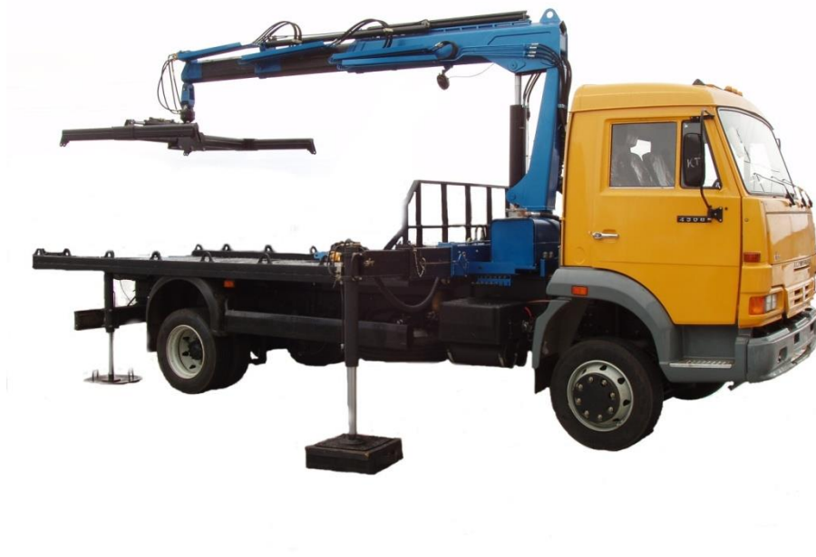
3 – сурет - Гидроманипуляторлы эвакуатор
