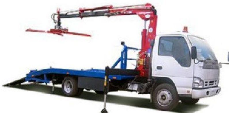
5 – сурет - Иілген платформалы және кранды эвакуатор
