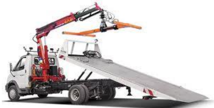
4 – сурет - Тік платформалы және кранды эвакуатор
