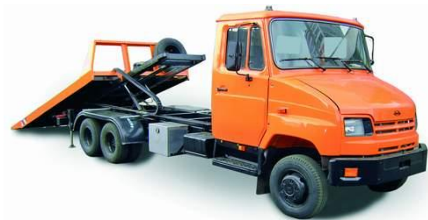
2 - сурет - Жылжымалы платформалы эвакуатор
