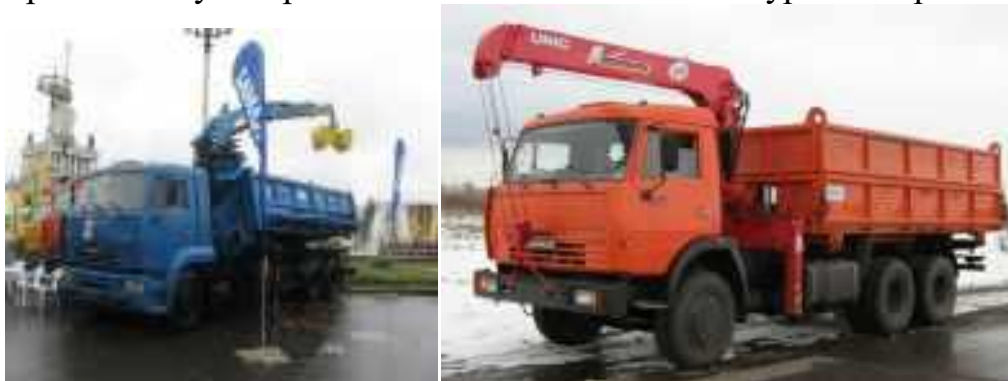
12 – сурет - ИМ-150 манипуляторы орнатылған КАМАЗ 65117 (6*4) самосвал автокөлігі.
